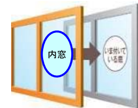
窓の断熱改修工事
